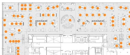
図4 ビーコン設置位置(丸印箇所)
