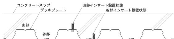
図 1 デッキ合成スラブに設置するインサート
