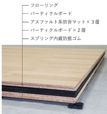
図 4 ダイワ式防音乾式浮き床
